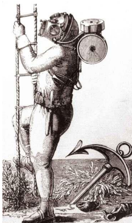
Appareil plongeur Rouquayrol-Denayrouze
